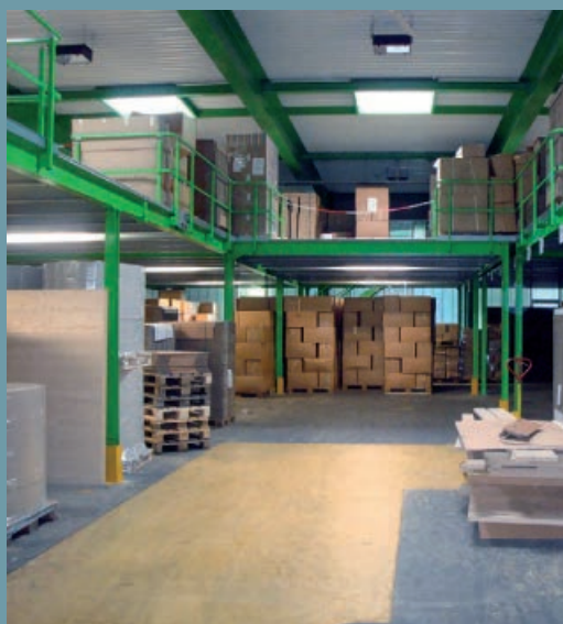
Construction de belle esthétique et planification et production conformes à l'utilisation prévue. Avec stations de transfert et signaux lumineux.
