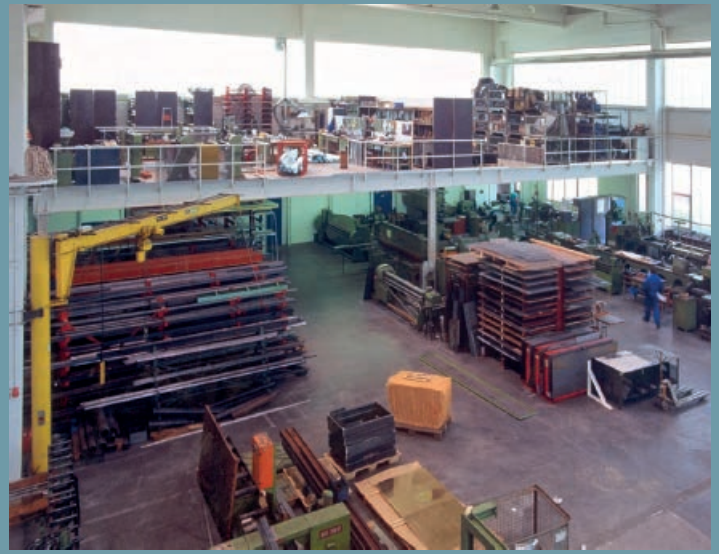
Surface de stockage double pour l'usinage de l'acier. Postes de travail en haut et en bas. Charge égale à 1.000 kg/m 2 .
