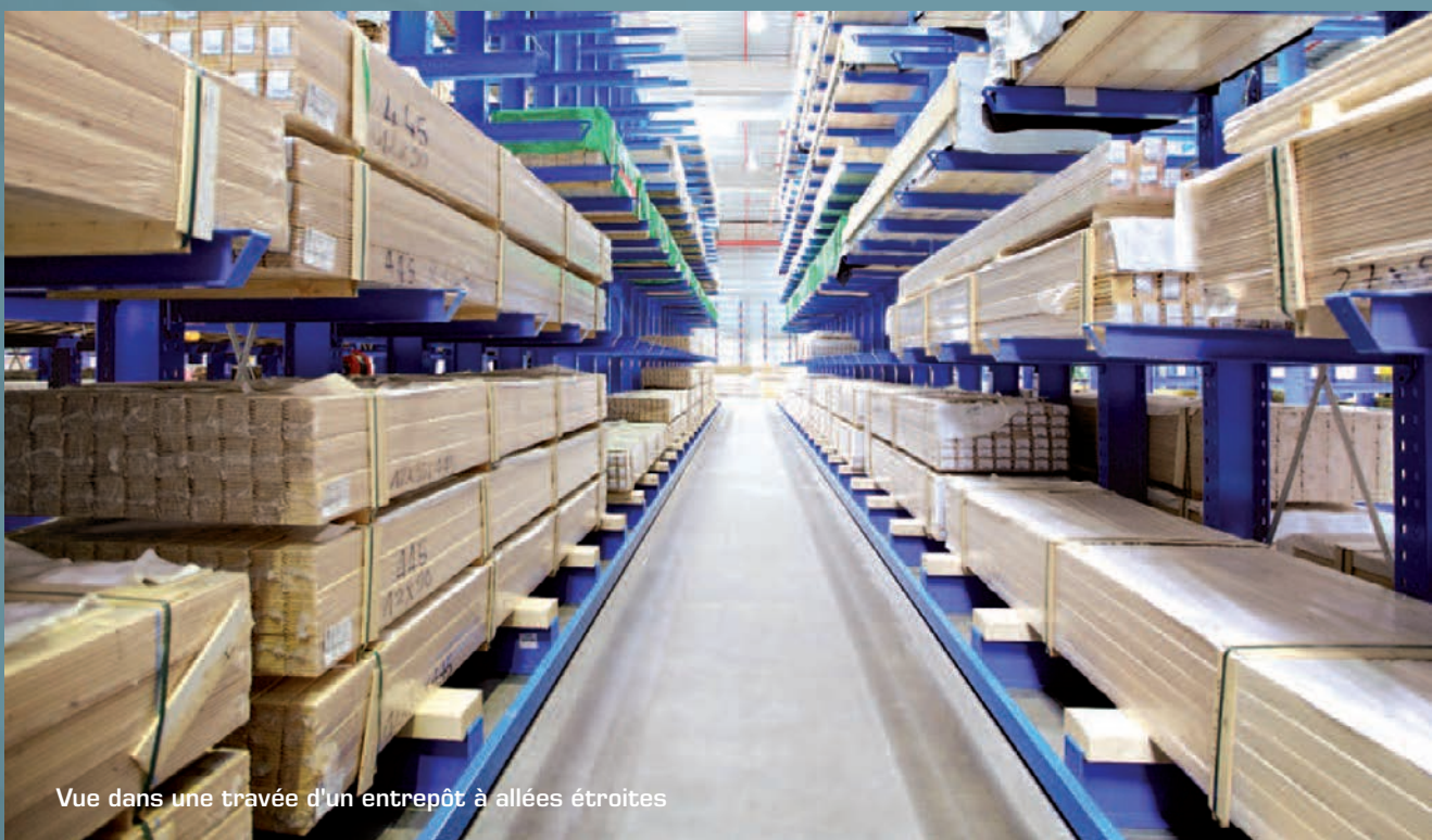
Rayonnages à bras portants double-face pour le stockage de bois avec des assortiments différents.
